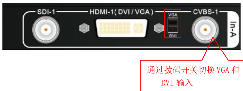
图 5-1a DVI-I 接口拨码开关
